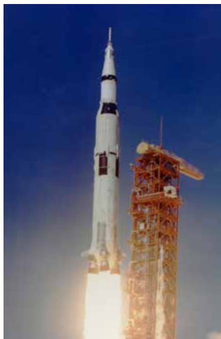
Wernher von Brauns Rakete Saturn V war so perfekt entworfen und gebaut, dass sie zur zweimal unbemannt getestet werden musste und nicht ein einziges Mal versagte. Sie hatte die unglaubliche Startmasse von knapp 3.000 Tonnen.
