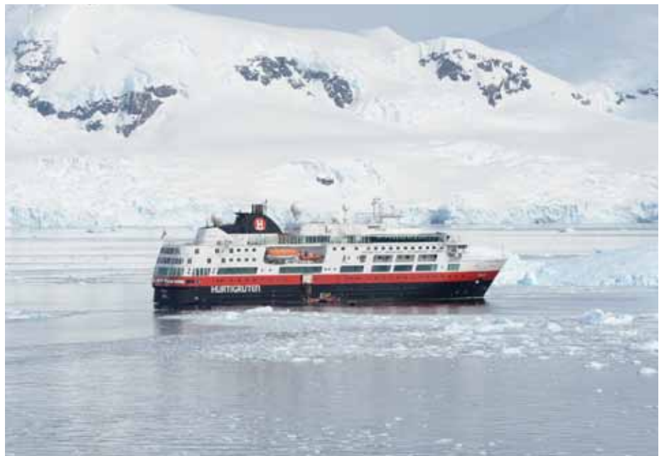
Die „MV Fram“ ist ein Schiff der Eisklasse 1A/B (eine Art „Eisbrecher light“), gleichzeitig das jüngste und modernst ausgestattete Schiff der Hurtigrutenflotte. Es kann gefahrlos in vereisten Buchten und Kanälen navigieren, in denen herkömmliche Schiffe nicht mehr fahren können.
